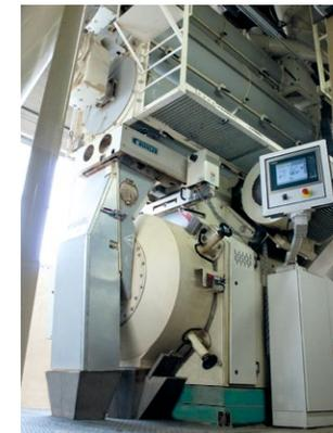
Unsere Press- und Hygienisierungsanlage: Bei der Pelletherstellung tötet sie schädliche Keime und Mikroorganismen ab.
